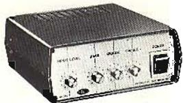
Modulatore di luce capace di pilotare 3 parchi lampade da 1 kW cad., con separazione dei toni provenienti dall'ingresso in bassi, medi e alti. L'eccellente sensibilità e la possibilità di regolazione del livello di intervento per ciascun tono, consentono una grande flessibilità d'impiego.
