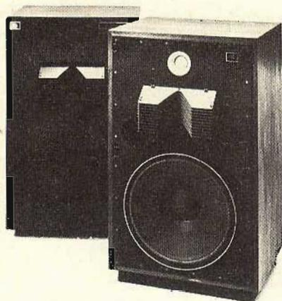
**Mod. C-500** - 3 Altoparlanti: 1 woofer a 12", mid-range a "cupola" e un tweeter a "dome" con network-crossover a 700 e 4.500 Hz (12 db per ottava) - In compressione pneumatica - 90 watt a 8 Ω da 20 a 20.000 c.p.s. - Dimensioni: 630x360x300/p. Costo netto di vendita al pubblico L. 200.000.
