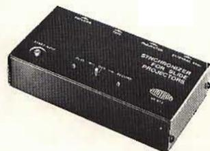
Il circuito comanda l'avvicendamento automatico delle diapositive nel proiettore, utilizzando una pista di registratore stereo per il segnale di comando, e l'altra per il commento sonoro.
