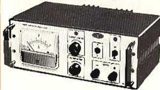
Un alimentatore da laboratorio di elevatissime caratteristiche di precisione e stabilità. Effettiva possibilità di regolazione da 0 a 20 V mantenendo in tutta la scala le caratteristiche di precisione. Limitazione di corrente variabile che permette anche un'erogazione a corrente costante.
