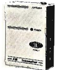
L'UK 355/C è un piccolo trasmettitore FM, molto economico, che può essere costruito in brevissimo tempo dato l'esiguo numero di componenti che fanno parte del suo circuito. Esso è adatto a coprire la gamma compresa fra 60 e 140 MHz, senza effettuare alcun cambio di bobine.
